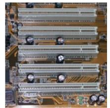
Esempio di slot PCI
