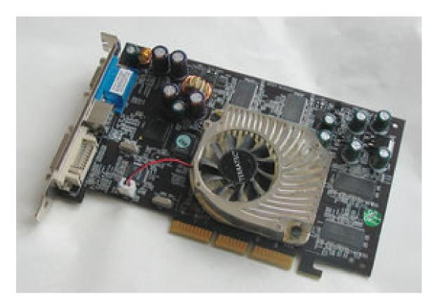
Immagine di una moderna scheda video <u>GeForce</u> 4200. Si noti il grosso <u>dissipatore</u> dotato di <u>ventola</u> per raffreddare la CPU ed i banchi di memoria disposti attorno.
